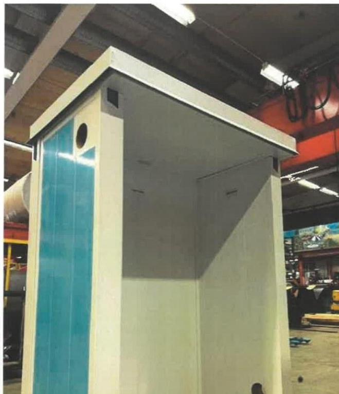
Bild 4 — Toppstycket monterat. Dörren förbereds för montage.
